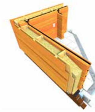
Omgekeerd systeem met strakkere detaillering, "oortjes" aan de binnenzijde wel zichtbaar, maar niet aan de buitenkant.
