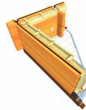
Normaal systeem met traditionele hoekverbinding (de zogenaamde "oortjes").
